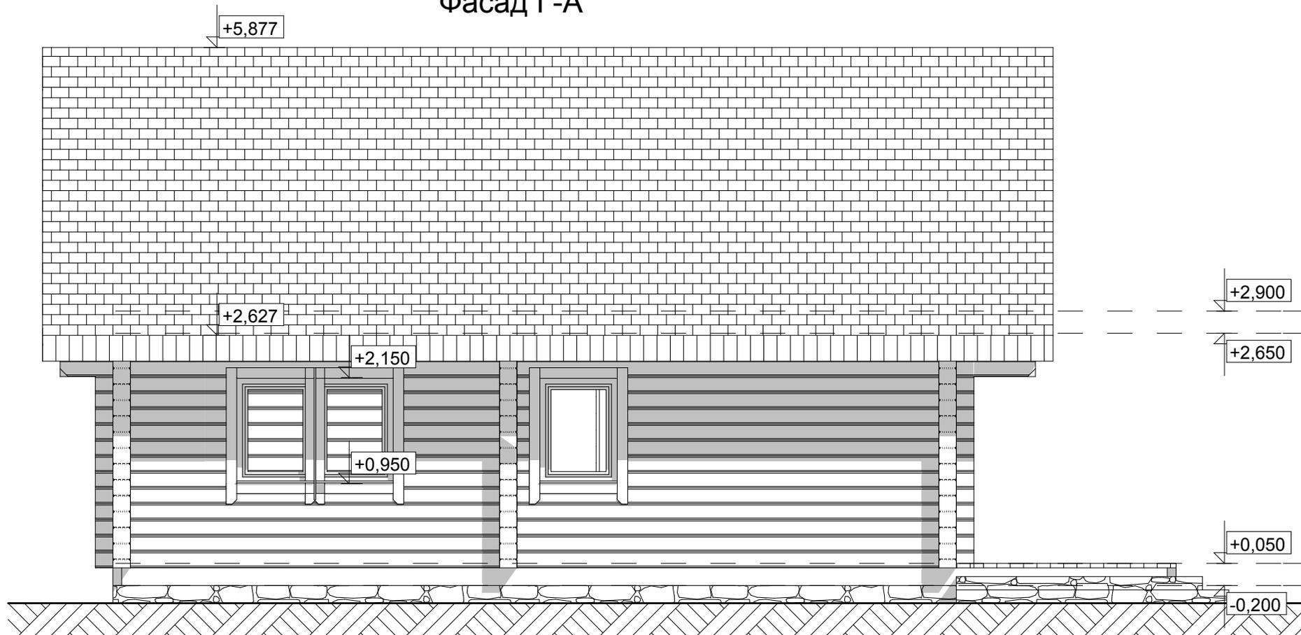
На планах, разрезах, фасадах, порядовках указаны размеры проемов под окна и двери.
