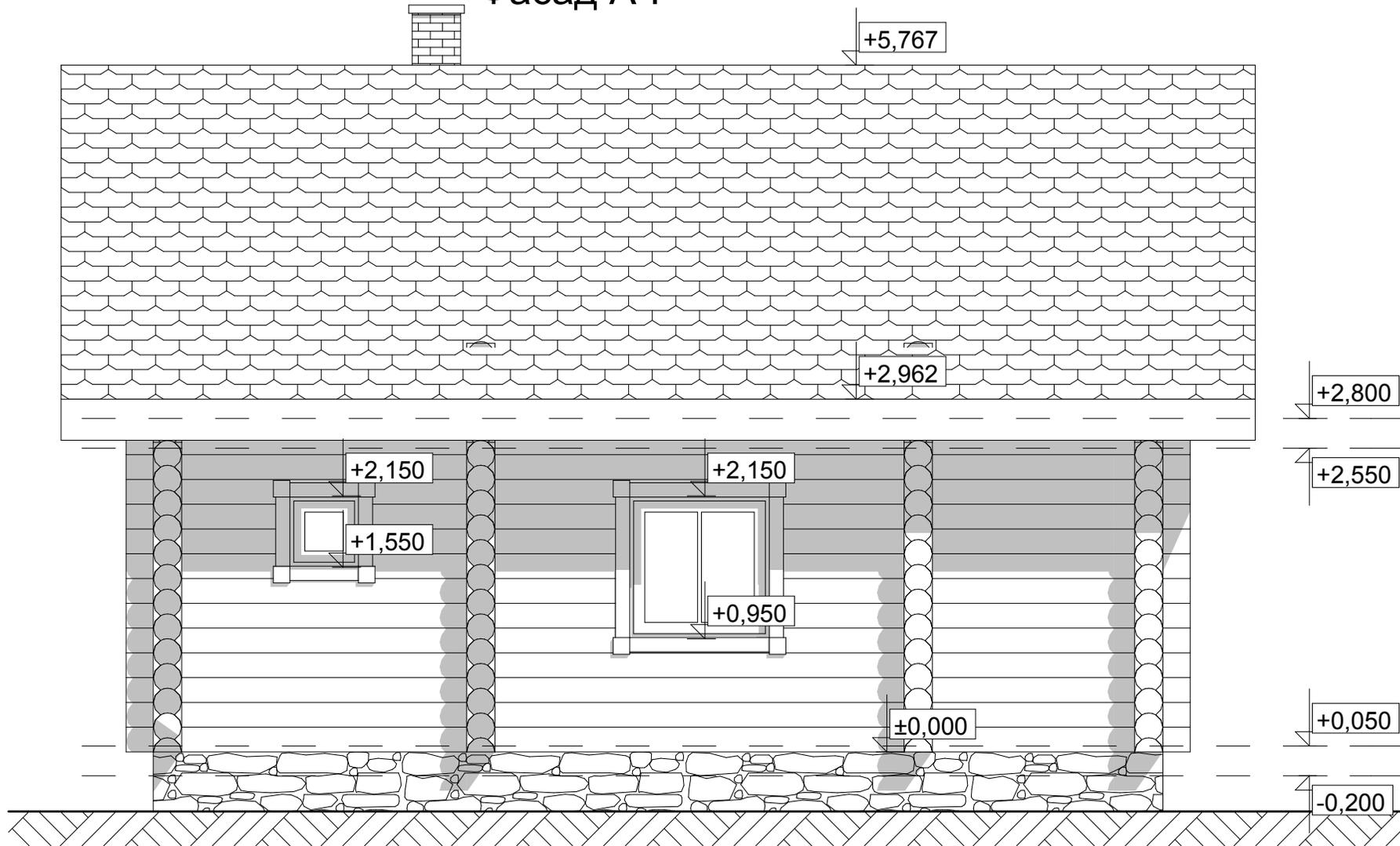
На планах, разрезах, фасадах, порядовках указаны размеры проемов под окна и двери.
