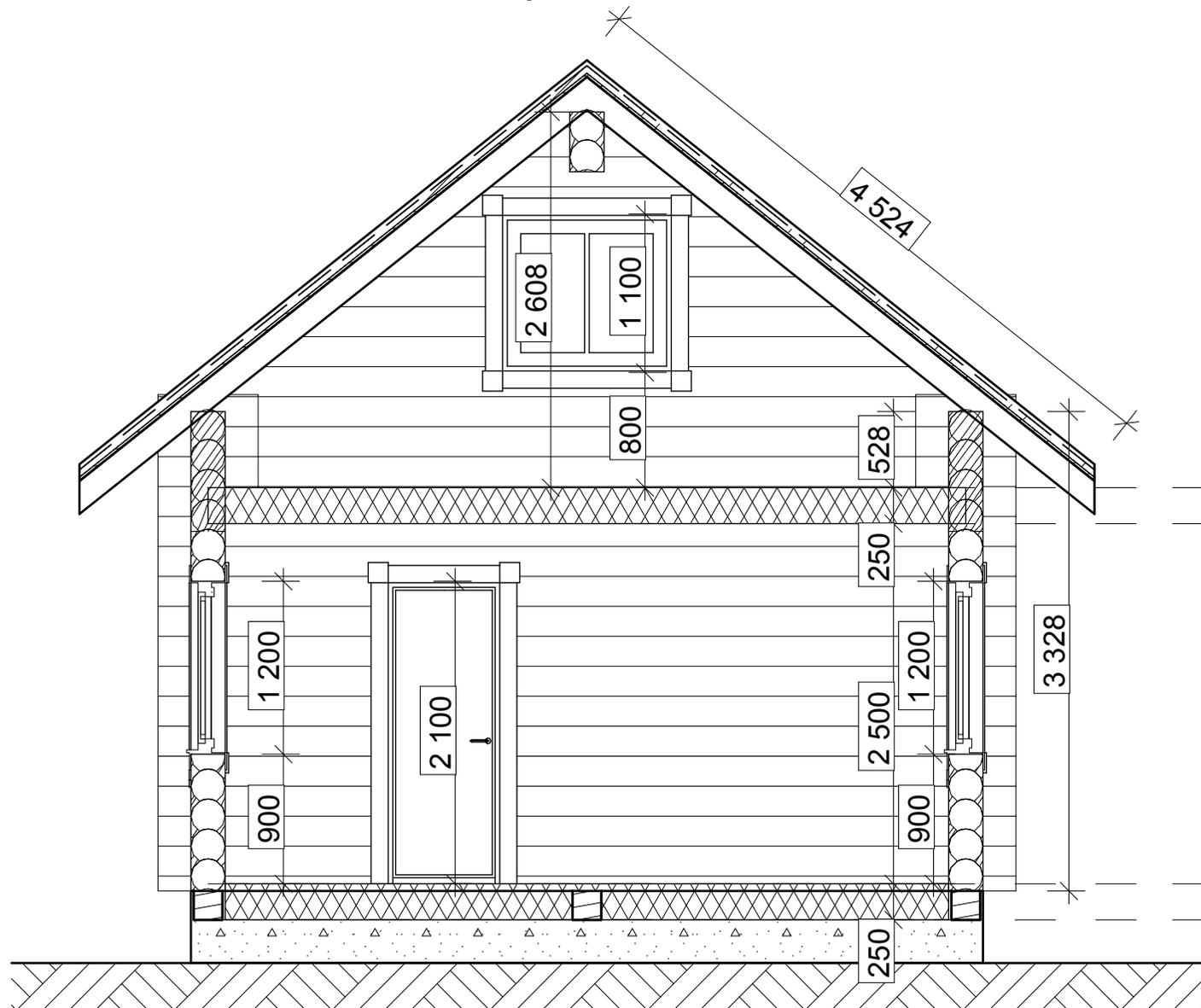
На планах, разрезах, фасадах, порядовках указаны размеры проемов под окна и двери.
